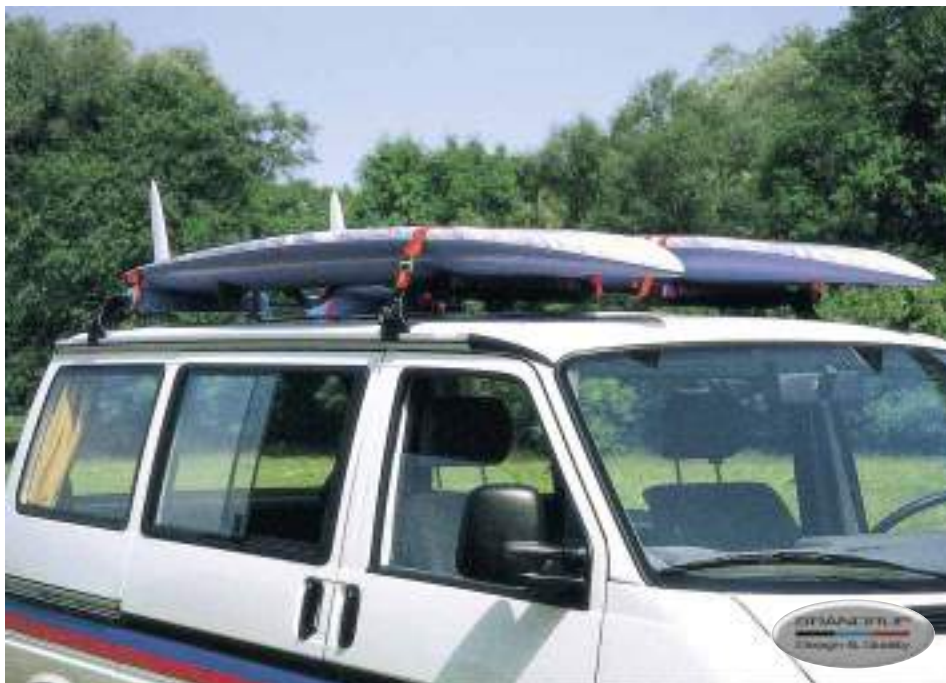
Sichere, einfache Befestigung von Dachlastenträgern mit Stützfüßen für Regenrinnen. Schnell abgenommen, wenn man das Dach öffnet.
