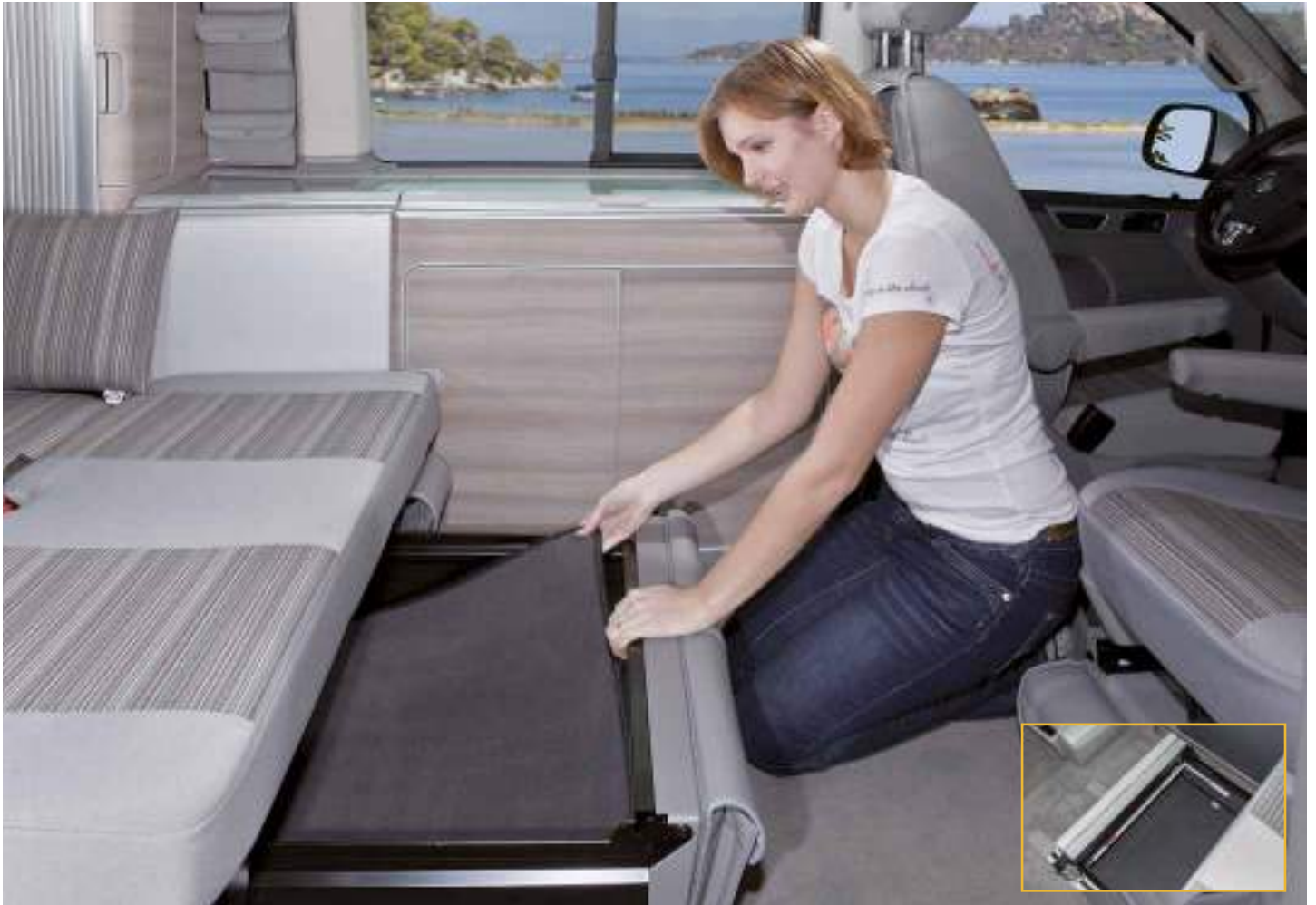
Geräuschdämm-Matte und -Set California T6.1/T6/T5: Sind ideal zur „Beruhigung“ der Blechschublade unter dem Bett (2er-Sitzbank): Abgelegte Sachen „klappern“ nicht mehr und sind besser geschützt. Die Markisenkurbel kann weiterhin eingeklipst werden. Die Geräuschdämm-Matte (Boden) wird in die Schublade eingelegt. Das Geräuschdämm-Set (Seitenteile) hat oben Klettverschluss.
